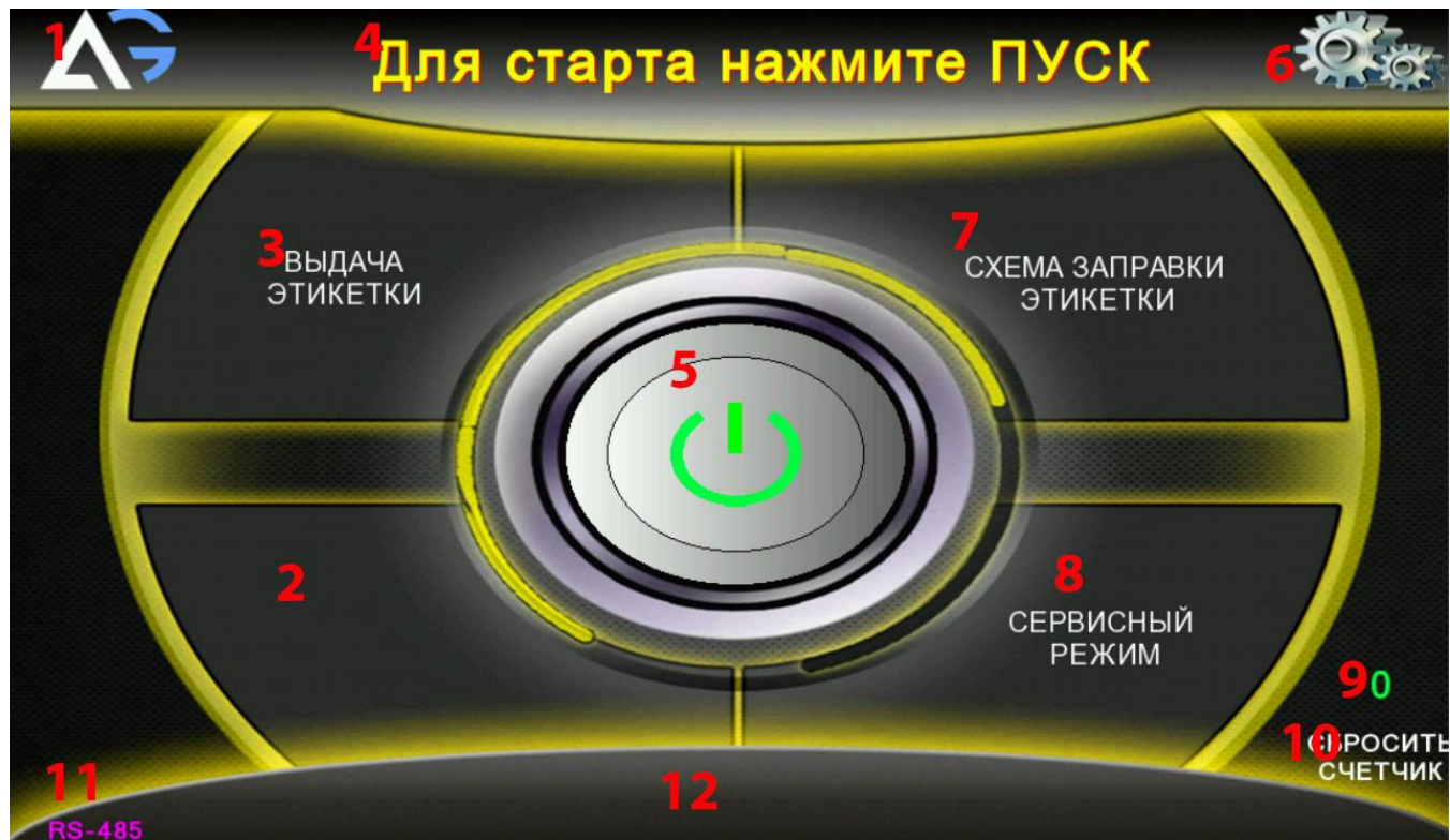
Рисунок 3.5. Основное меню принтера-аппликатора Н-ПР-01.
